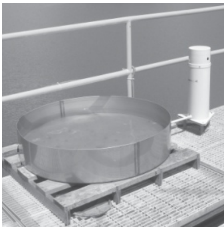
Estação de evaporação
